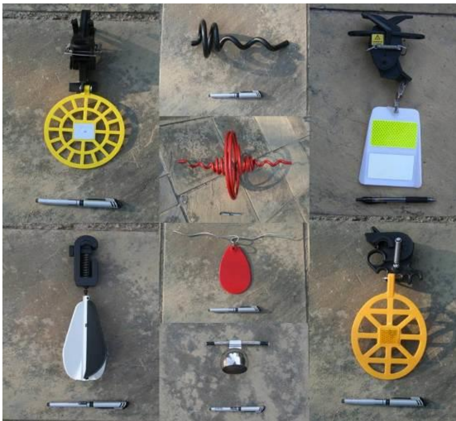
Figura 21. Varios dispositivos de marcación de líneas (incompletos). En cada foto, un bolígrafo (aprox. 14 cm de largo) sirve a modo de escala (foto: EWT-WEP).
