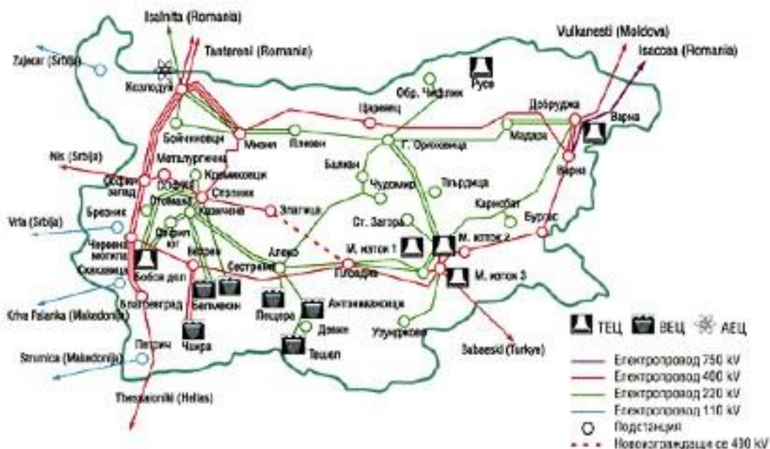
Figura 1. Red de transmisión de Bulgaria. Fuente: NEK (ABS Energy Research, 2011). La red de distribución no se muestra.
