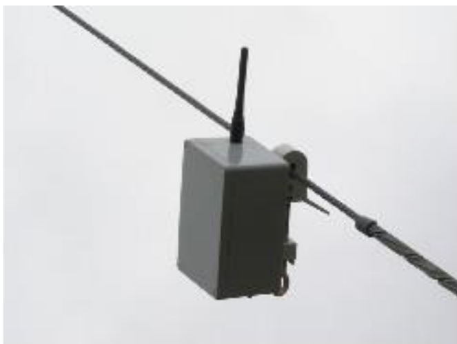
Figura 22. Indicador de Impactos de Ave (BSI) adjunto a un tendido eléctrico. El BSI es un dispositivo relativamente pequeño que puede adjuntarse a un único cable de una línea eléctrica y registrar automáticamente las colisiones de aves en base a las vibraciones del cable.
